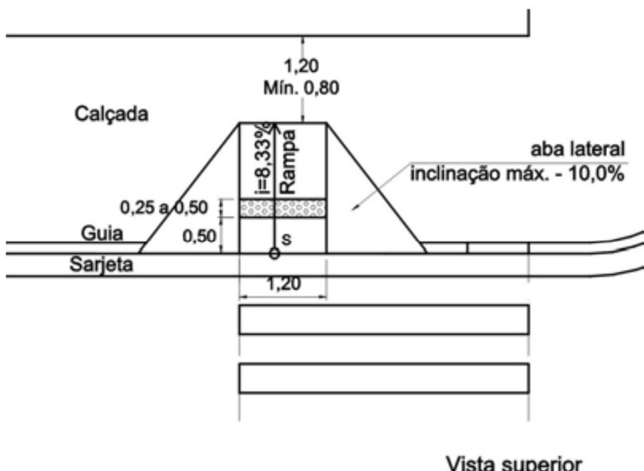
Esquema da Rampa (Fonte: NBR 9.050)
