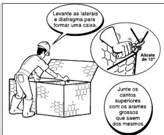
Figura 07 - Anéis laterais e diafragmas
