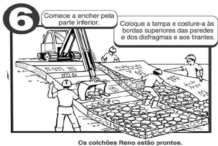
Figura 20 – Enchimento e fechamento dos colchões.
